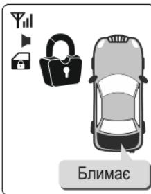
Після закриття багажника датчик удару знову буде повернено в стан охорони. Якщо в машині немає кінцевого вимикача багажника, Ви можете натиснути КН-1, щоб повернути датчик удару в охорону. Або через 10 хвилин датчик удару автоматично буде повернено під охорону.
