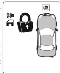
Четверте натискання на КН-1 поверне датчик удару в зону охорони і прозвучать 4 сигнали сирени.
