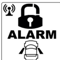
**Сработал концевой выключатель дверей.**
