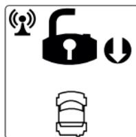
Для включения этой функции, надо снять сигнализацию с охраны, и не позднее 15 секунд нажать одновременно на **КН1 + КН2** и удерживать пока сирена выдаст один короткий сигнал, а пульт управления мелодичный сигнал высокого тона. На экране отобразится соответствующий значок , указывающий на включенную функцию.
